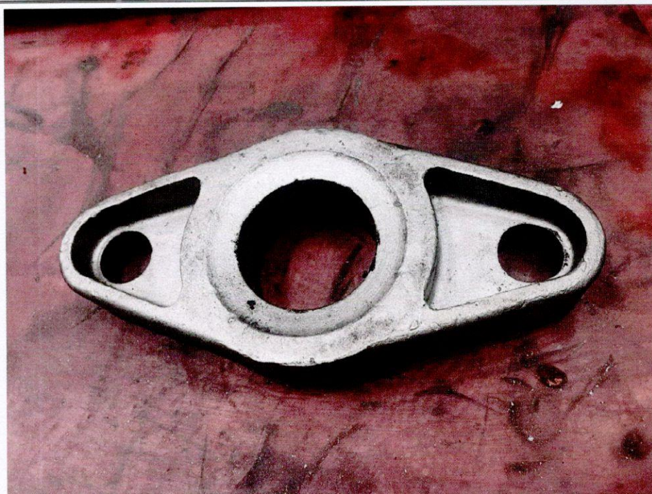
填料压盖 Gland flange
