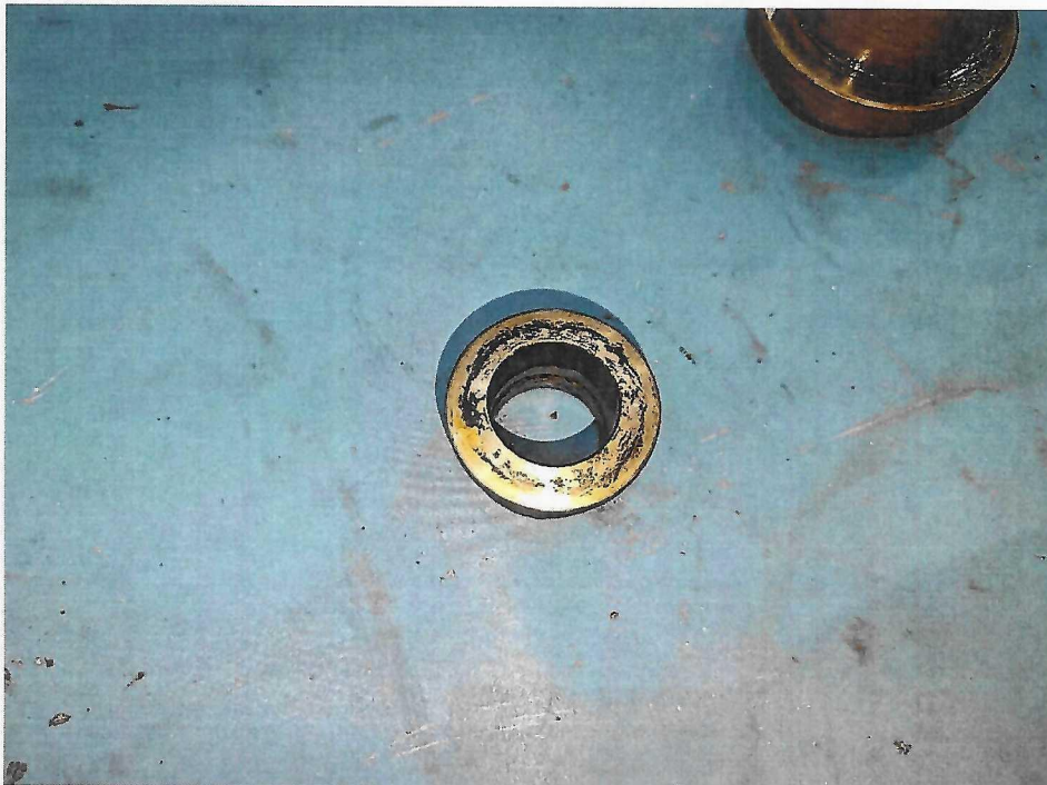
填料压套 Packing gland
