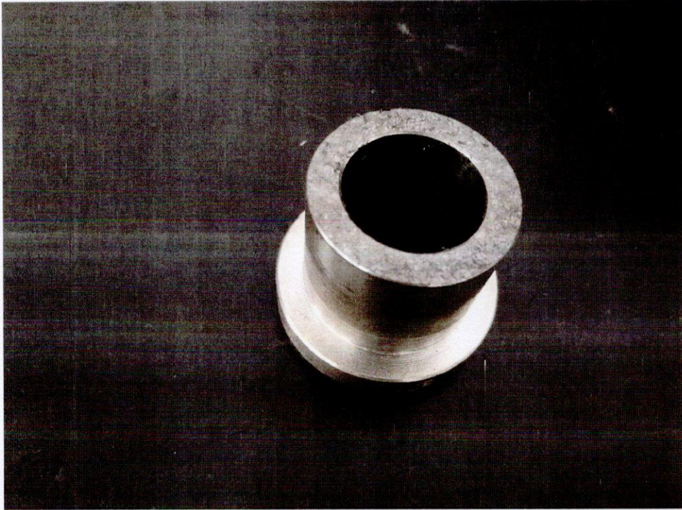
试验后的填料压套 Gland follower after test
